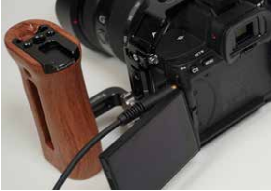
Der Kopfhörer-Stecker blockiert das (nicht länger) rotierbare Display
