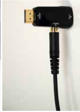
Ein HDMI-VGA Adapter mit Klinkenbuchse löste das Problem
